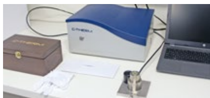
TCi – en termisk konduktivitetmätare från C-Therm, som mäter värmeledningsförmågan.
