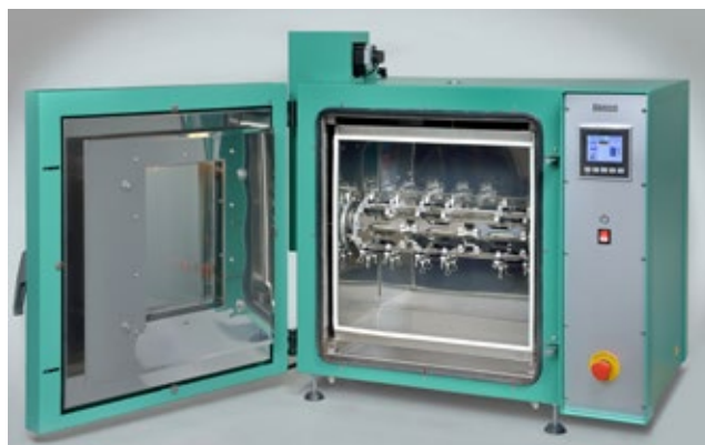
Åldringsskåpet EB 26HT har hög lufthastighet och en invändig karusell för snabb och enkel montering av upp till 36 provkroppar. Karusellen roterar i innerkammaren under provningen.
