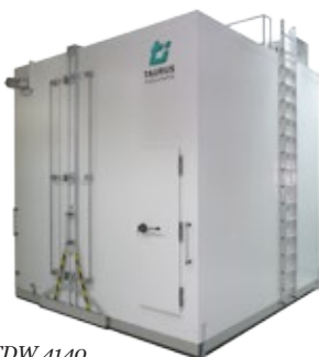
TDW 4140 med varmlåda (guarded hotbox).
