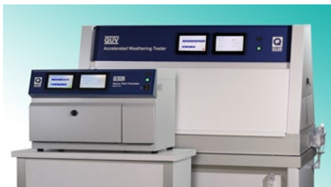
Q-SUN Xe-1 xenonkammare och QUV-skåpet för accelererad väderåldring med UV-ljus och fukt finns tillgängliga för väderprovning i Elastocons provningslaboratorium.
