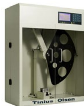
Pendelslagprovare för plast, modell IT 503 – för bestämning av slagseghet enligt Charpy (ISO 179, ASTM D6110) och enligt Izod (ISO 180, ASTM D256).
