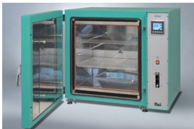
Åldringsskåp EB 04-II har låg lufthastighet och en flödesmätare som kan ställas in på 3 till 20 luftombyten per timme, vilket uppfyller ISO 188 metod A.
