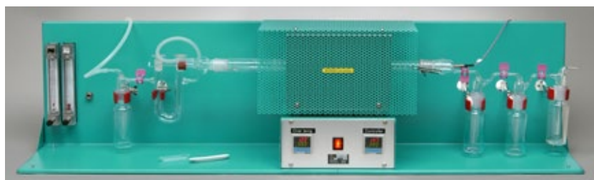
Rörugn ES 14 används för bestämning av askhalt och kimirökhalt.
