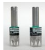
Roterande knivar dia 10, 13 eller 16 mm för tillverkning av provkroppar ur provplattor eller färdiga produkter.
