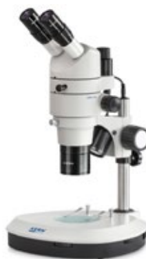
Stereomikroskop KERN OZS-5, förstoringsgrad 8x till 80x.
