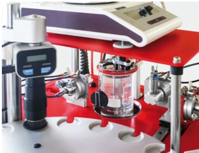
MonTechs automatiserade provningsinstrument H&D 3000 för kombinerad hårdhets- och densitetsmätning.
