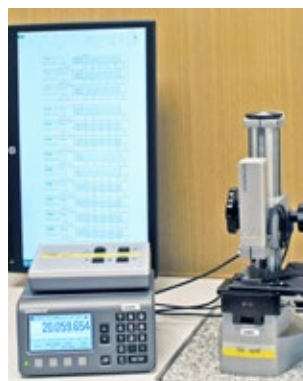
Kalibrering av passbitar i passbitskomparator.
