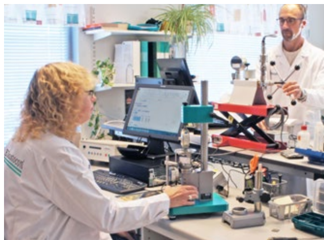
Det allmänna laboratoriet för kalibrering vid 23 °C. Utöver detta har vi ett konstantrum för kalibrering av längd vid 20 °C ± 0,5 °C, samt ett rum för temperaturkalibrering.
