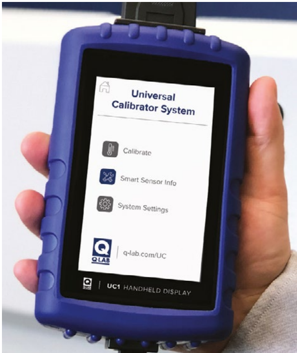
Q-Labs universella kalibratorsystem UC1 är en handhållen enhet för kalibrering av irradians och temperatur i QUV- och Q-SUN-utrustning för väderprovning.
