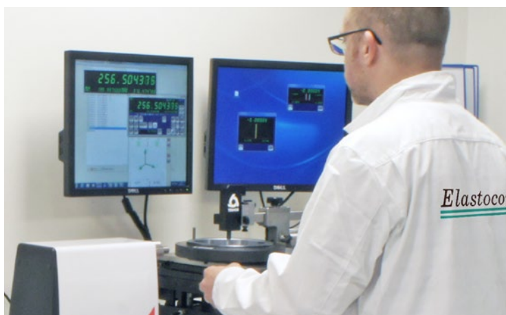
Utöver det allmänna laboratoriet för kalibrering vid 23 °C har vi ett konstantrum för kalibrering av längd vid 20 °C ± 0,5 °C, samt ett rum för temperaturkalibrering.
